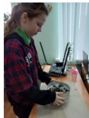
Для определения рН методом водной вытяжки, небольшое количество почвы я помещала в колбу, добавляла дистиллированную воду в три раза больше по объёму, и встряхивала колбу около одной минуты. Затем полученную взвесь фильтровала через фильтровальную бумагу, вставленную в воронку.
